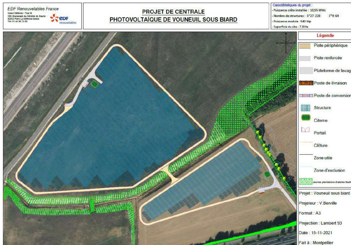
Figure 123 : Variante d'implantation n°3 (Source : EDF Renouvelables)
